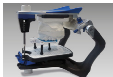
Transferstand zur Übertragung der Oberkieferlage in mechanische Artikulatoren unter Verwendung des Kopplungsöfffels.
