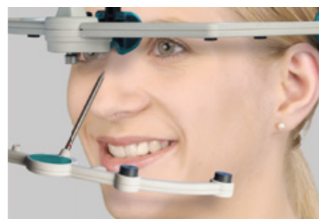
Die Taststiftfunktion ermöglicht die Aufzeichnung des Gesichtsprofils und beliebiger Punkte im Gelenkbereich sowie auf der Okklusalfäche.
