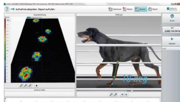
Das System besteht aus einem mit kalibrierter Drucksensormatrix instrumentierten Laufband oder Messplattform, sowie einer oder mehreren synchronisierten Kameras.
