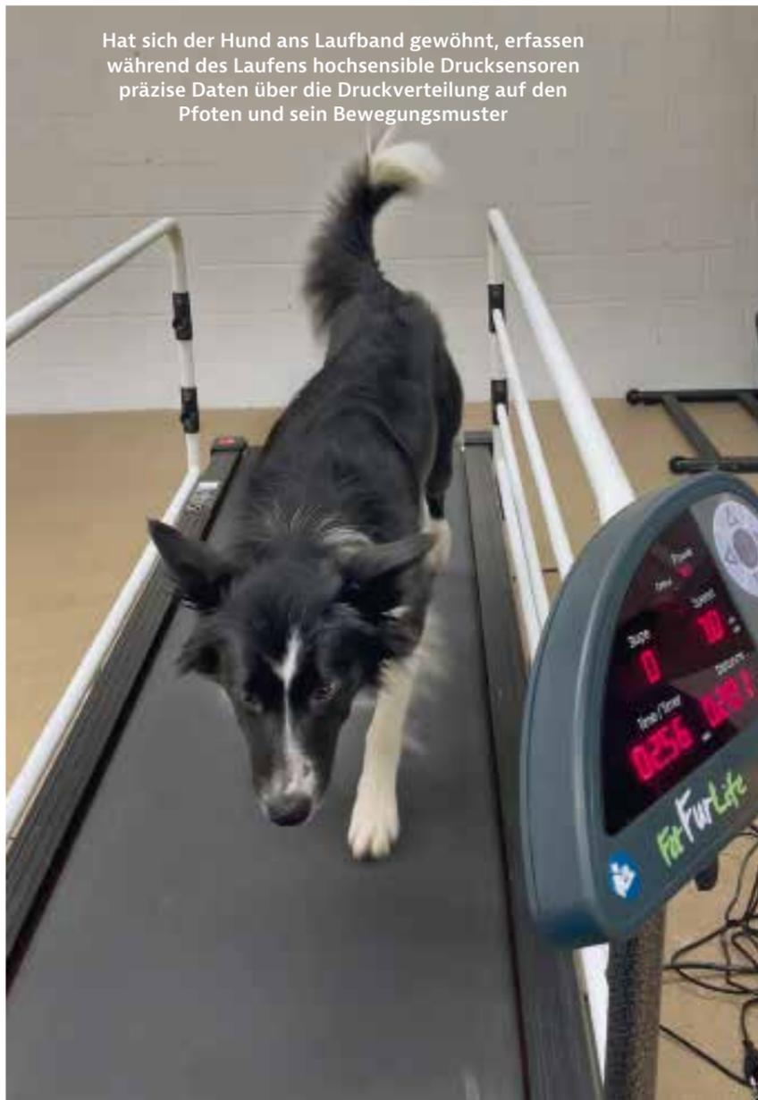
Hat sich der Hund ans Laufband gewöhnt, erfassen während des Laufens hochsensible Drucksensoren präzise Daten über die Druckverteilung auf den Pfoten und sein Bewegungsmuster
